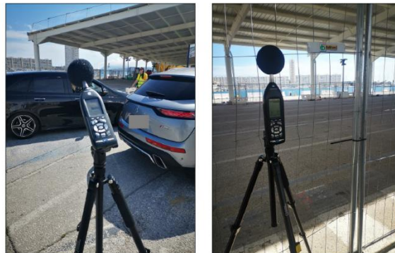
Figure 4 - Sonomètres pour les reliefs près des auvents d'ombrage
